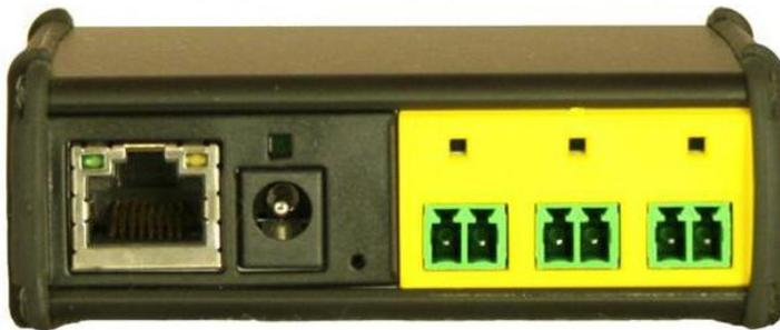
此模块的 IP2CC 是需要外接一个电源，具有网络接口和 3 个 relay 口
